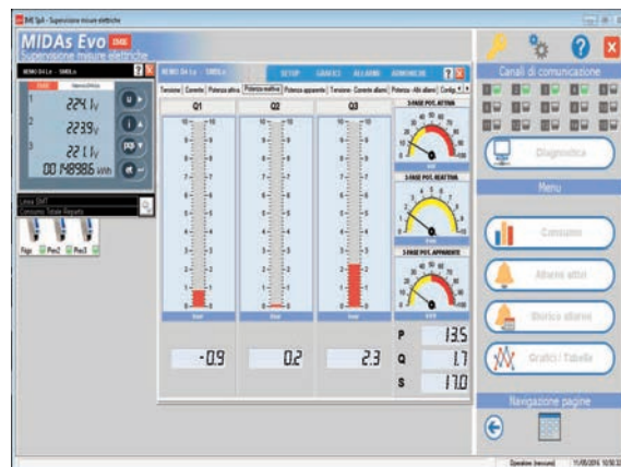
Potenza Reattiva / Reactive Power
